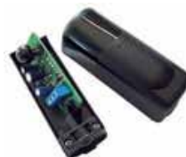
A10093 A PARETE DA ESTERNO ORIENTABILI DE SUPERFICIE PARA USO ESTERNO ORIENTABLE Coppia di fotocellule a parete da esterno, alimentazione 12 o 24 Vac/dc uscita con contatti NC e NA. Il sensore ottico di questa fotocellula può essere orientato di 180° in orizzontale e di qualche grado in verticale, permettendone l'installazione su superfici non parallele senza l'utilizzo di staffe o supporti angolari. Fotocélula de uso externo, alimentación 12 o 24 Vac/dc salidas NC y NA. El sensor óptico de esta fotocélula puede ser orientado a 180° en horizontal y de algunos grados en vertical, permitiendo la instalación en superficies no paralelas.
