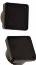
A10085 A INCASSO DA ESTERNO PARA EMPOTRAR DE USO ESTERNO Coppia di fotocellule a parete da incasso, alimentazione 12 o 24 Vac/dc, uscita con contatti NC e NA. Fotocélula de uso externo para empotrar, alimentación 12 o 24 Vac/dc, salidas NC y NA.
